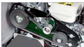
Frizione a cinghia, con disinnesto automatico al rilascio della leva di comando.
