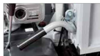
Ribaltamento manuale con sistema di bloccaggio automatico.
