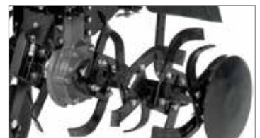
Trasmissione ad ingranaggi in bagno d'olio, resistente e con ridotta manutenzione.
