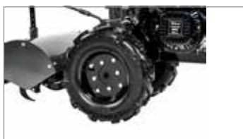
Ruote di grandi dimensioni per facilitare la manovrabilità della macchina durante l'utilizzo.
