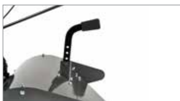
Fresa da 50 cm con regolatore di profondità.
