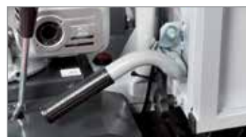
Ribaltamento manuale con sistema di bloccaggio automatico.
