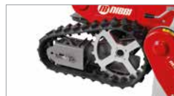
Sistema di trazione a cingoli, oscillanti si adattano alle varie tipologie di terreno.
