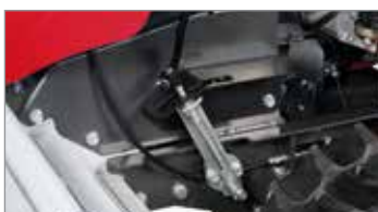
Leva selezione marce diretta posta a lato piantone, di sicuro inserimento.
